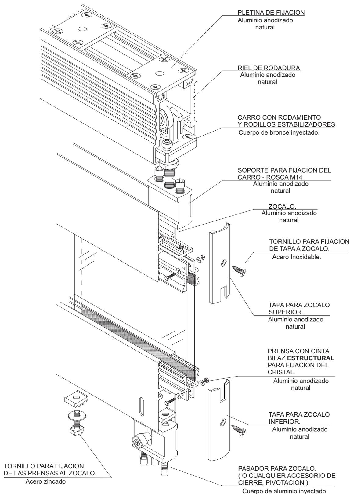
LOS PERFILES SE ENTREGAN ANODIZADOS EN TONO NATURAL O SEGUN MUESTRA COLOR SOLICITADA POR EL CLIENTE. LOS COLORES PODRAN SER POR ANODIZADO O POR PINTURAS EN POLVO.
